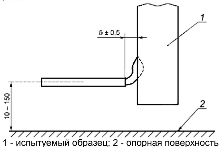
Рисунок 2 - Положение горелки с игольчатым пламенем
