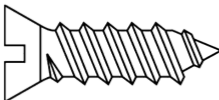
Рисунок 1 - Самонарезающий формирующий винт (3.3.22)
