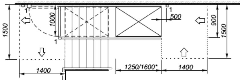
Рисунок В.25 Параметры наклонных подъемников
