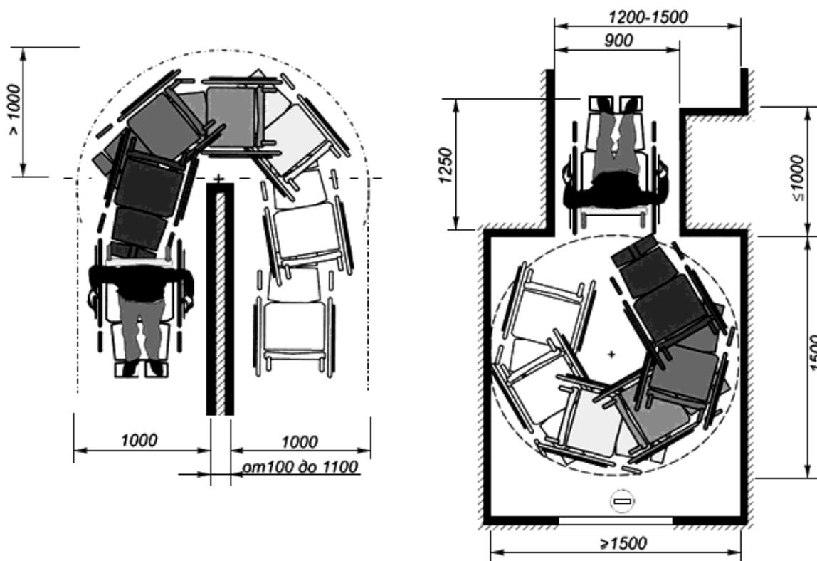
Рисунок В.9 Габариты поворотов и разворотов кресла-коляски
