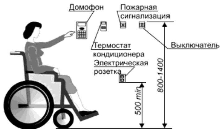
Рисунок Г.6 Досягаемость оборудования
