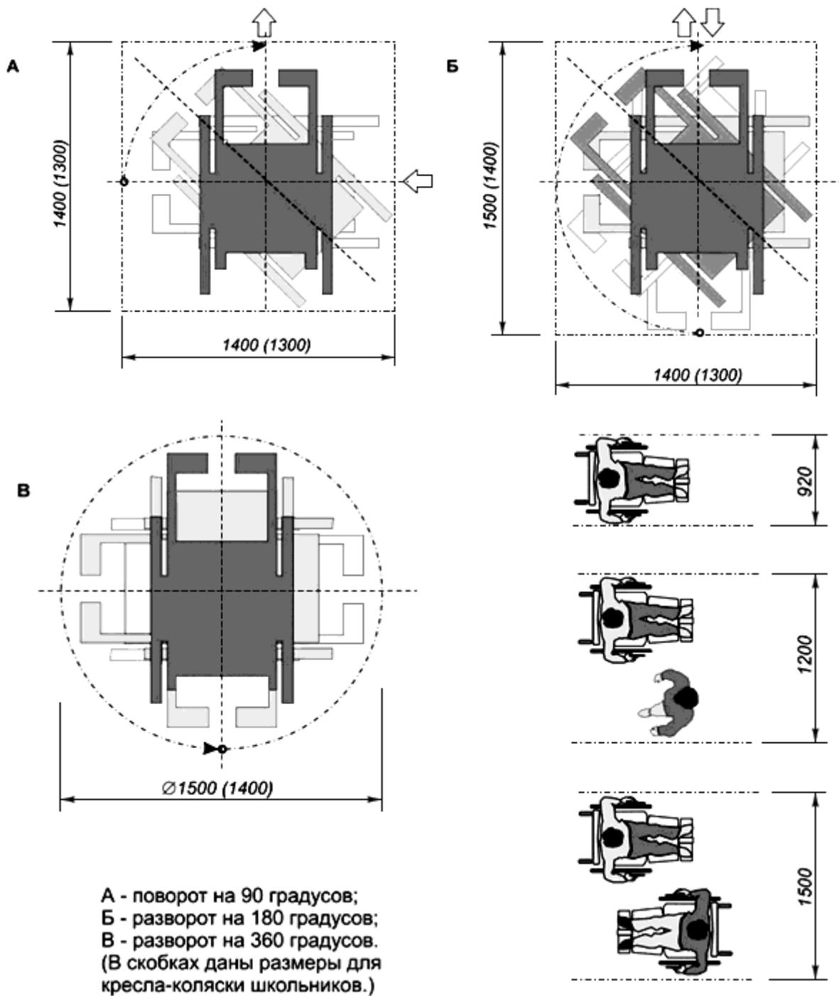
Рисунок В.3 Параметры занимаемой зоны при вращении и движения МГН на кресле-коляске
