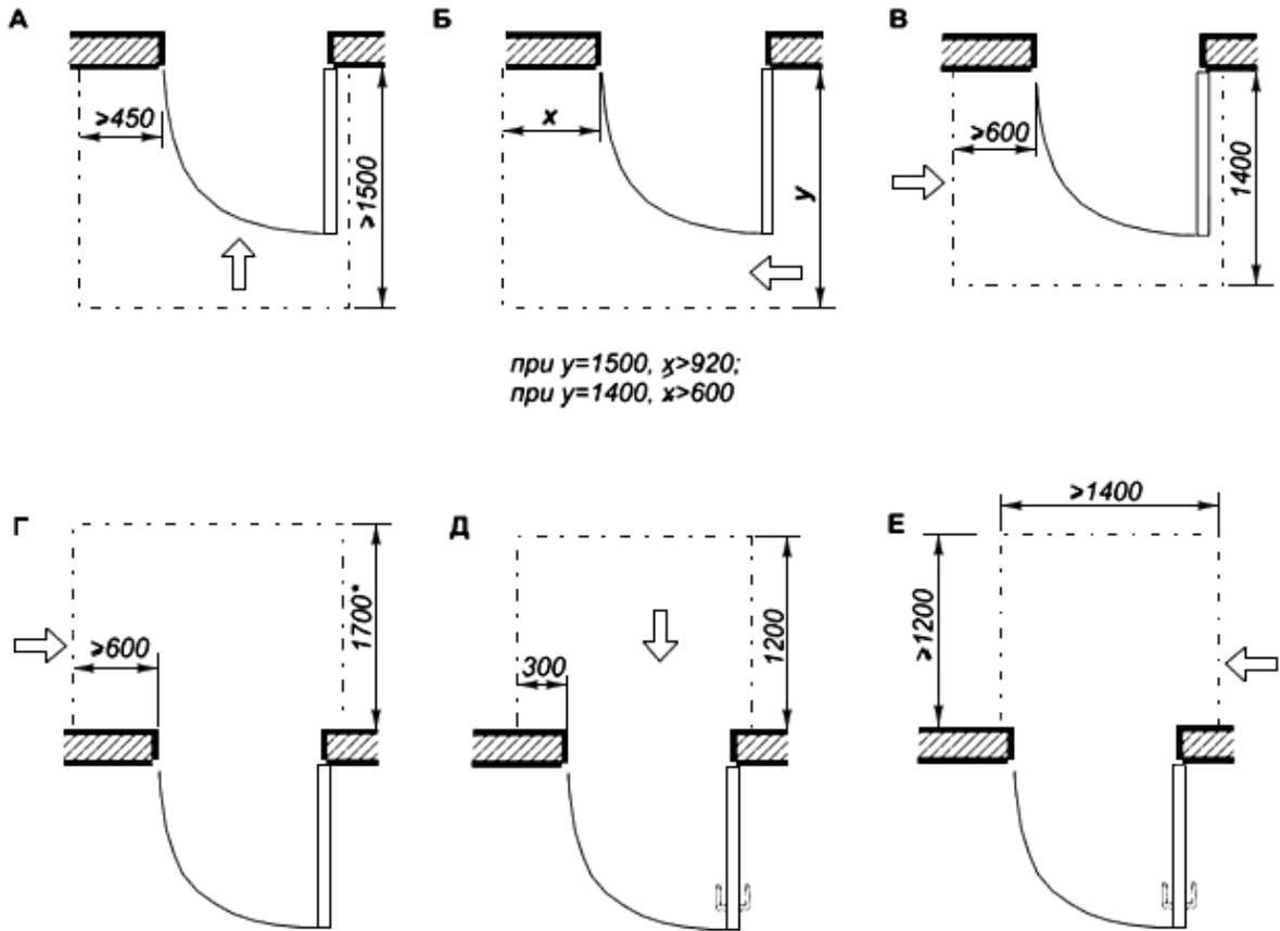
А,Б,Г - двери без запора; В - дверь с закрывателем, Д,Е - двери имеют ручку и закрыватель
