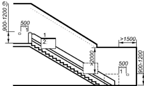
а) - перемещение подъемника параллельно лестнице; б) - перемещение лестничного подъемника (над ступенями);
