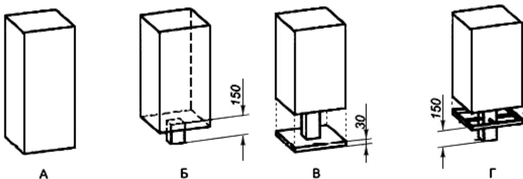
А - элемент доходит до пола; Б - низ элемента возвышается на полом не более 150 мм; В - опорная плоскость элемента не менее 30 мм толщиной; Г - осязательная планка на высоте не менее 150 мм над полом.
