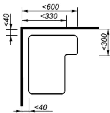
Рисунок Г.9 Габариты душевых кабин
