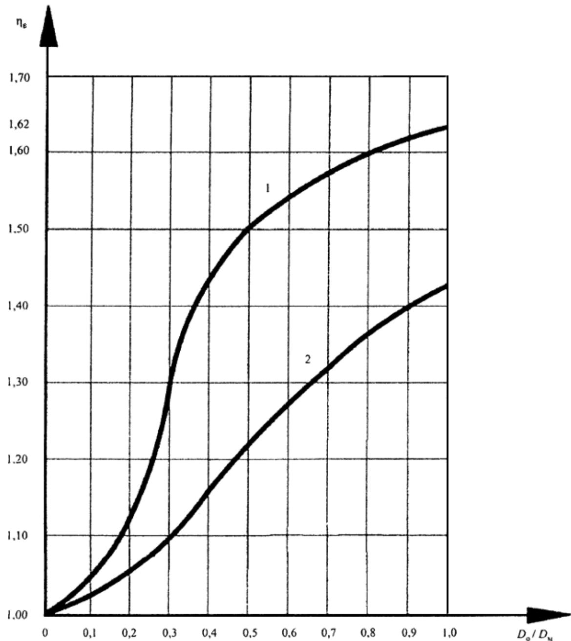
$\eta_B$  - коэффициент несущей способности деталей;  $D_0 / D_m$  - отношение наружного диаметра ответвления тройника к наружному диаметру основной трубы тройника
